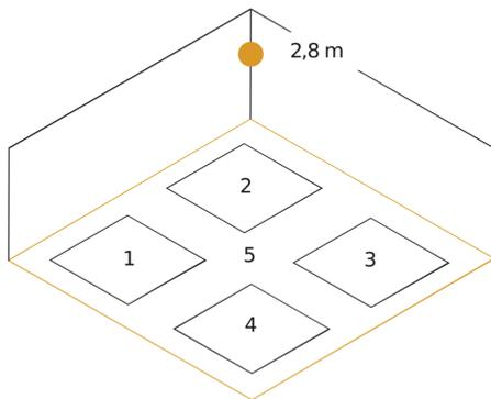
Possibile altezza di montaggio: 2,30 m - 6,00 m
